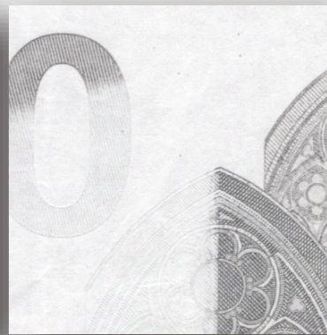
IR-Licht erfasst die IR-Reflexion einer Banknote
